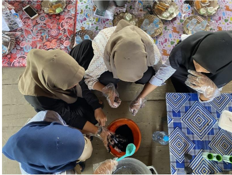
Gambar 5. Proses pencampuran serbuk briket dengan bahan perekat (tepung tapioka)
