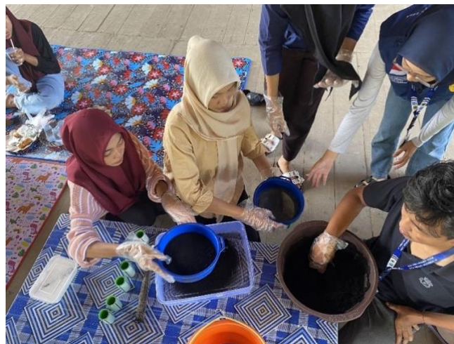
Gambar 4. Proses pengayakan serbuk bonggol jagung yang telah dibakar
